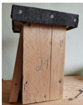
Vorderwand mit offener Seitenwand 2, Loch für Hakennagel links
